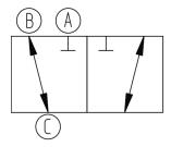
PROGEF Standard 3-Weg Kugelhahn Typ 286 Horizontal/L-Bohrung Ohne Handbetätigung Mit Schweissmuffen metrisch
