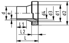
**PROGEF Standard Adapter für Absperrklappen SDR17.6**
